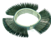
1 четков колан 23 мм, прав, закален връх Използвайте за отстраняване на боя, покрития (например уплътнители) и ръжда без пясъкоструен ефект.
